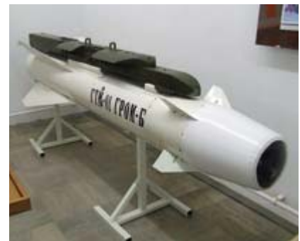
Ракета ваздух–земља „гром-Б“ са ТВ главом за самонавођење
